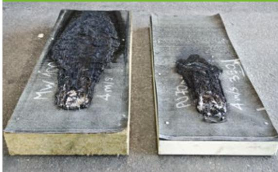
Confronto tra i campioni al termine della prova con ventilazione a 4 m/s. A sinistra il campione isolato in lana minerale che non ha superato il test e a destra quello in poliuretano con una zona danneggiata inferiore ai 55 cm previsti per l'ottenimento della classe  $B_{\text{roof}}(t_2)$ . Il test comparativo si è svolto a parità di prestazioni isolanti.
