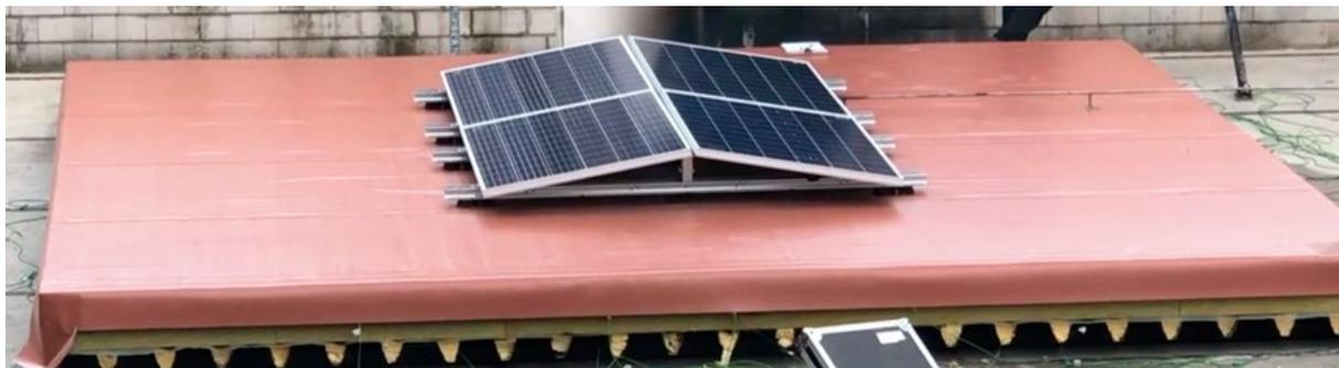
Il sistema fotovoltaico era composto da pannelli fotovoltaici con fogli posteriori in alluminio classificati in classe C secondo IEC 61730-2. I quattro pannelli (dimensioni totali 3,2 m x 1,84 m, angolo al tetto 13°) sono stati montati in una configurazione back-to-back con orientamento est-ovest largamente utilizzata nell'Europa settentrionale e occidentale.
