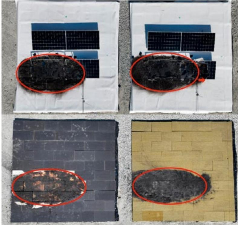
Le aree danneggiate dei due campioni prima e dopo la rimozione della membrana impermeabile. Sono relativamente simili con una lieve maggiore estensione verso il perimetro esterno dell'area danneggiata del campione in lana minerale MW.
