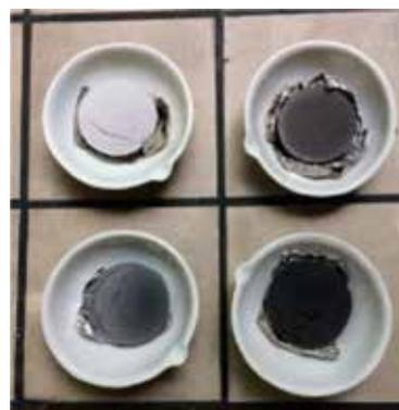
*L'aspetto visivo di alcuni esempi di formulati (n° 3, 6, 8 e 10) dopo il trattamento termico in muffola a 700°C.*
