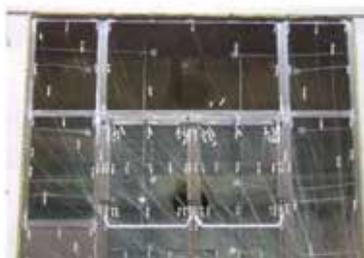
*Prove di resistenza al fuoco per due tipologie di manufatti: pannelli metallici coibentati e serramenti per superficie vetrate.*
