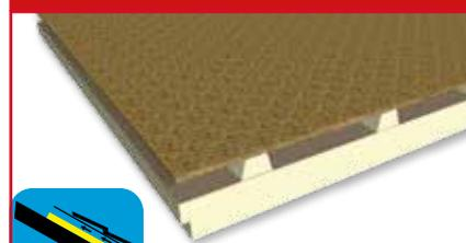
Sistema termoisolante per la realizzazione di coperture ventilate costituito da pannelli RF3, in schiuma polyiso rivestiti in multistrato Duotwin, con distanziatori in XPS, accoppiati a lastre lignee in multistrato fenolico idonee per impieghi strutturali in ambienti umidi.
