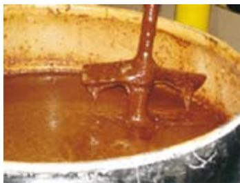
dosare una miscela di solido+liquido (slurry) da inserire, come componente aggiuntivo, nei vari processi tecnologici del poliuretano, applicati alla produzione di pannelli isolanti.
