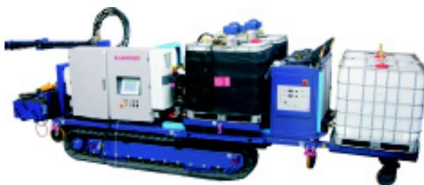
La Società Cannon ha presentato il nuovo impianto mobile di schiumatura "A-mobile" sviluppato per rispondere alle esigenze di realizzazione o riparazione di isolamenti termici in situ mediante iniezione di schiuma poliuretanica. L'impianto completamente automatizzato può essere caricato in container ed è quindi particolarmente funzionale per le esigenze del settore della cantieristica navale e delle costruzioni in genere.
