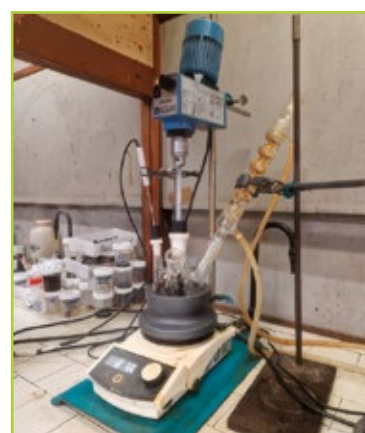
Glicolisi: l'apparecchiatura di prova
