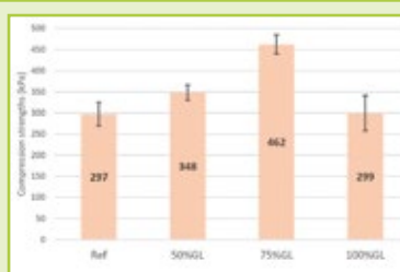
Resistenza a compressione delle schiume prodotte con diverse percentuali di poliolo da riciclo di PU - PET mediante glicolisi.
