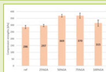
Resistenza a compressione delle schiume prodotte con diverse percentuali di poliolo da riciclo di PU - PET mediante glicolisi e amminolisi.
