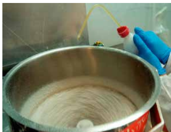
Figura 4 e 5: Miscelazione degli scarti con il legante
