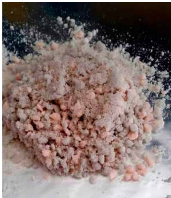
Figura 3: Scarti industriali di schiume rigide dopo il processo di macinazione meccanica.
