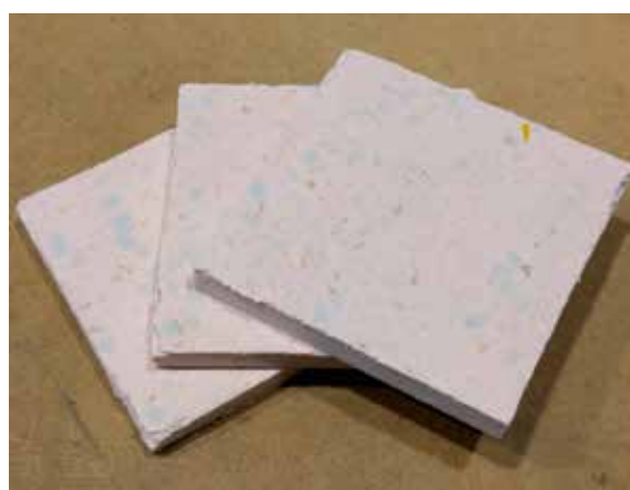
Figura 7: Pannelli prodotti mediante processo di riciclo re-bonding
