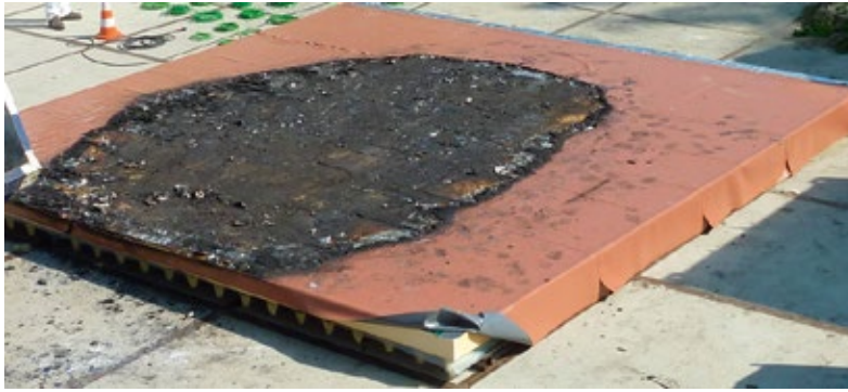
Fig. 5a Campione isolato con PIR Area superficiale danneggiata dopo la rimozione dei pannelli fotovoltaici
