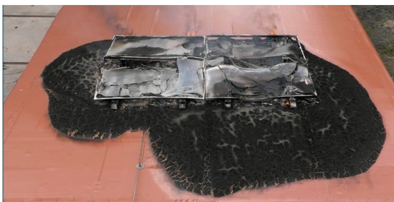
Fig. 3b. Area danneggiata campione isolato con MW
