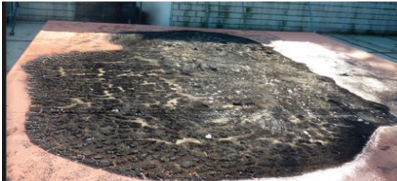
Fig. 5b Campione isolato con MW Area superficiale danneggiata dopo la rimozione dei pannelli fotovoltaici
