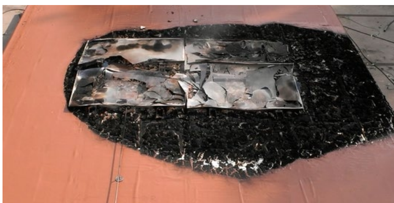
Fig. 3a. Area danneggiata campione isolato con PIR
