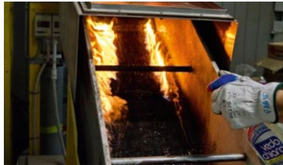
*Nella prova con velocità dell'aria a 2 m/S il pacchetto isolato con poliuretano si è autoestinto a 9' e 37" e la zona danneggiata è risultata pari a 480 mm.*
