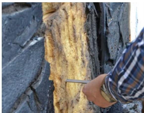
*Al termine della prova si è provveduto alla rimozione dello strato superficiale carbonizzato allo scopo di valutare lo spessore di schiuma poliuretanicata ancora integro e non attaccato dalle fiamme.*
