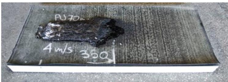
Confronto tra i campioni al termine della prova con velocità dell'aria 4 m/s. In alto il campione isolato con poliuretano, in basso quello con lana minerale che non ha superato la prova.
