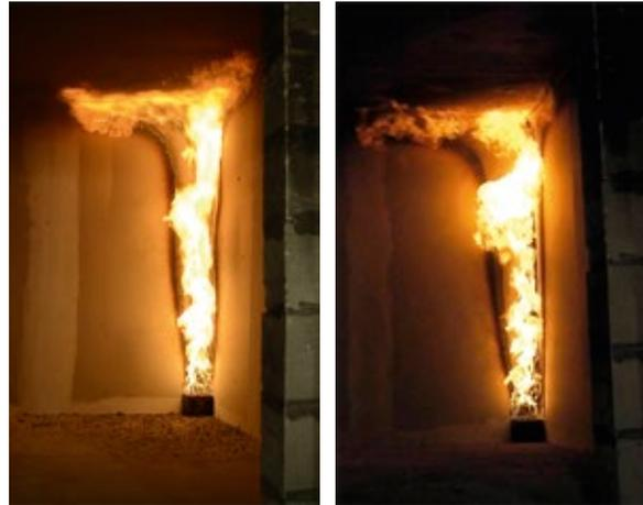
*I due campioni (poliuretano e cartongesso a sinistra e lana minerale e cartongesso a destra) nella fase del test con attacco termico a 300 kW rappresentativa di un incendio già sviluppato.*
