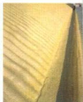
Puretan 50 è un poliuretano a celle chiuse ad alta densità che impermeabilizza ed isola contemporaneamente. È un rivestimento continuo applicabile nello spessore desiderato. È ottenuto mediante spruzzatura in luogo con macchine ad alta tecnologia.
