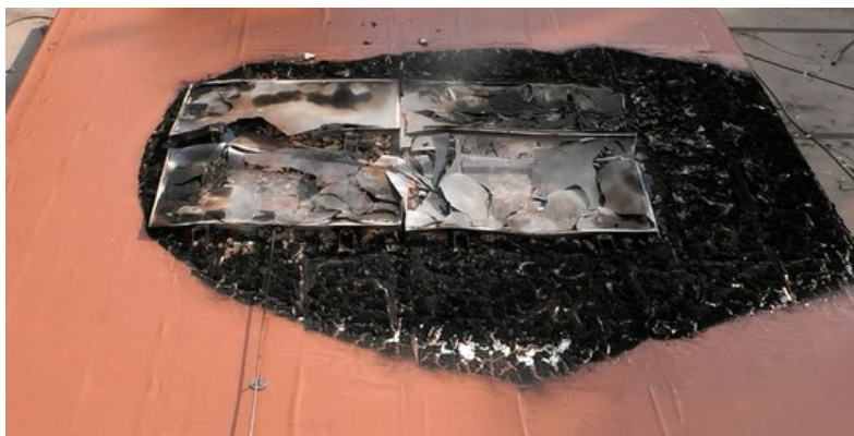
Fig. 3a. Area danneggiata campione isolato con PIR
