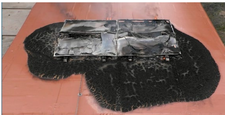
Fig. 3b. Area danneggiata campione isolato con MW
