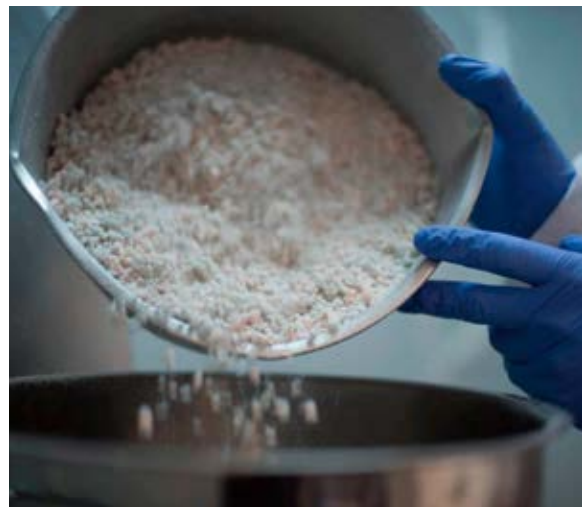
Figura 3: Scarti industriali di schiume rigide dopo il processo di macinazione meccanica.
