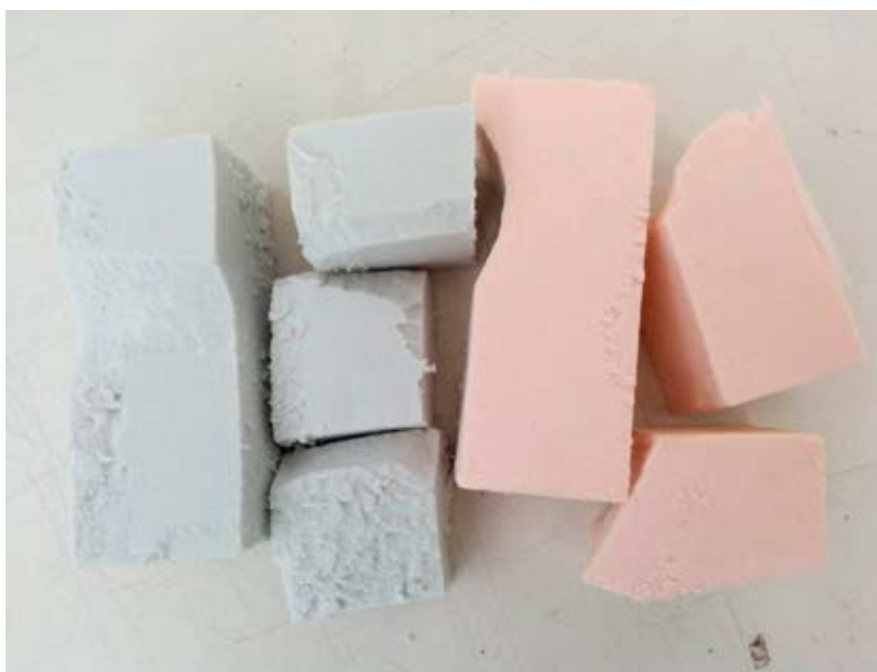
Figura 1: Scarti industriali di schiume rigide prima del processo di macinazione meccanica
