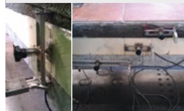
Figura 9. Dettaglio disposizione DD1 nel tegolo: misura delle deformazioni e dello schiacciamento del pacchetto.
