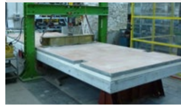
Figura 7. Prova a flessione del campione tegolo TT con finitura in piastrelle
