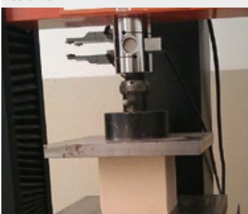
Figura 3. Test di un provino di materiale isolante
