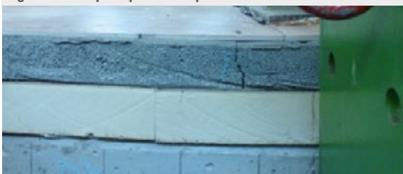
Figura 15. Campioni predalles: quadro fessurativo rilevato
