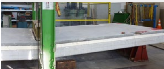
Figura 15. Campioni predalles: quadro fessurativo rilevato
