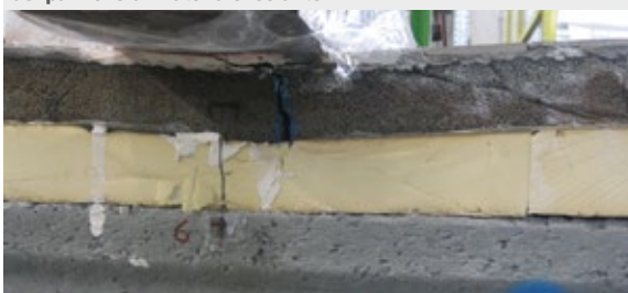
Figura 17. Campioni alveolari: particolare della rottura localizzata del pannello di materiale isolante.
