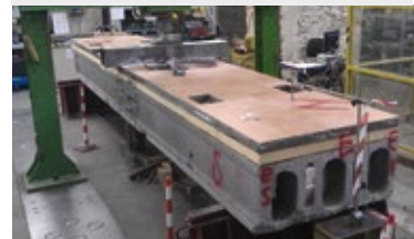
Figura 9. Dettaglio disposizione DD1 nel tegolo: misura delle deformazioni e dello schiacciamento del pacchetto.
