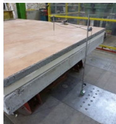
Figura 10. Disposizione degli LVDT nel pannello predalles.
