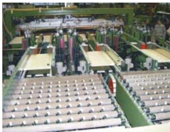
Foto: Sistema di profilatura multipla di pannelli in poliuretano
