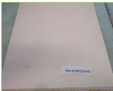
Campione ETICS in poliuretano pre-invecchiamento
