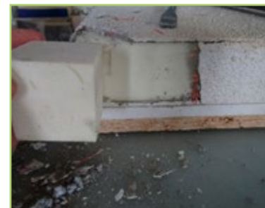
Pannello in poliuretano pre invecchiamento e campione ETICS post invecchiamento
