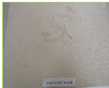
Campione ETICS in poliuretano post invecchiamento
