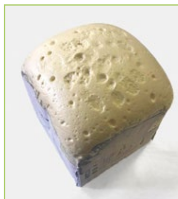
Esempio di schiuma poliuretanicca ottenuta con poliolo glicolizzato.
