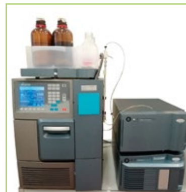
Il sistema HPLC utilizzato durante questa tesi è composto da una pompa ad alta pressione (Water E2695 System Controller), un termostato (Water Oven TCM), una colonna e un rivelatore UV/Visibile (Water 2489 Photodiode Array Detector).
