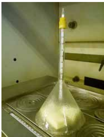
Campioni sottoposti alla prova di invecchiamento per umidità
