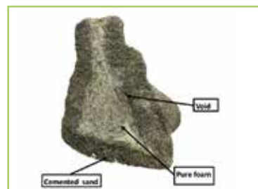
Sezione campione PUR + sabbia
