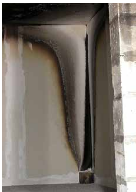
I due campioni (poliuretano e cartongesso a sinistra e lana minerale e cartongesso a destra) al termine del test.
