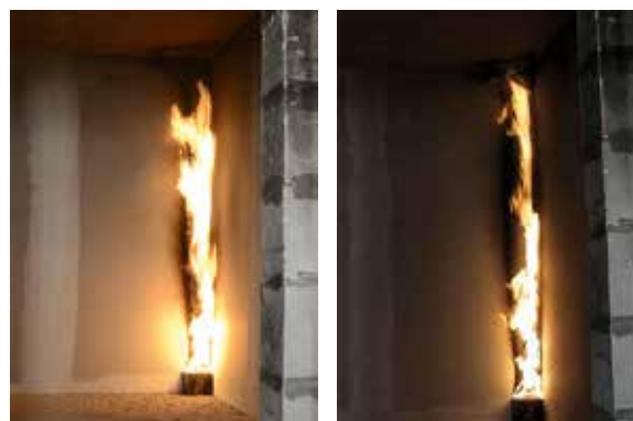
I due campioni (poliuretano e cartongesso a sinistra e lana minerale e cartongesso a destra) nella fase del test con attacco termico a 100 kW che simula la fase iniziale dell'incendio.
