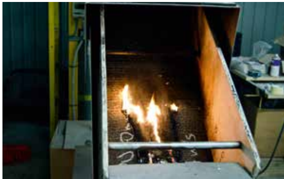
Confronto tra i campioni al termine della prova con velocità dell'aria 2 m/s. A sinistra il campione isolato con poliuretano, a destra quello con lana minerale.
