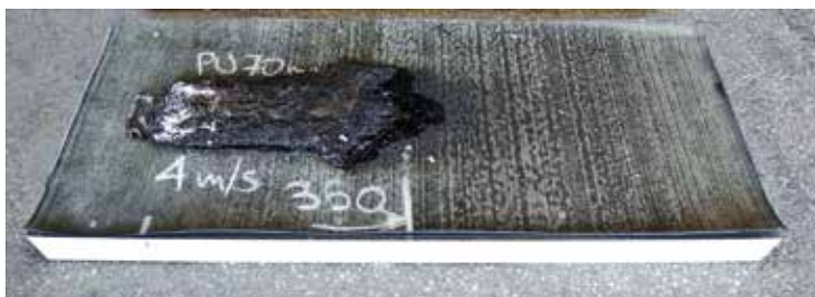
Confronto tra i campioni al termine della prova con velocità dell'aria 4 m/s.
