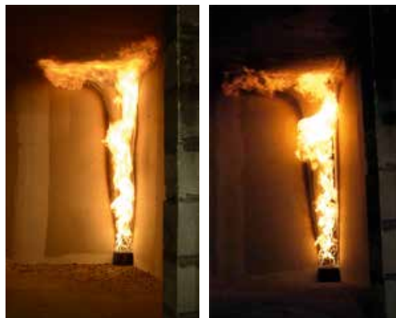
I due campioni (poliuretano e cartongesso a sinistra e lana minerale e cartongesso a destra) nella fase del test con attacco termico a 300 kW rappresentativa di un incendio già sviluppato.
