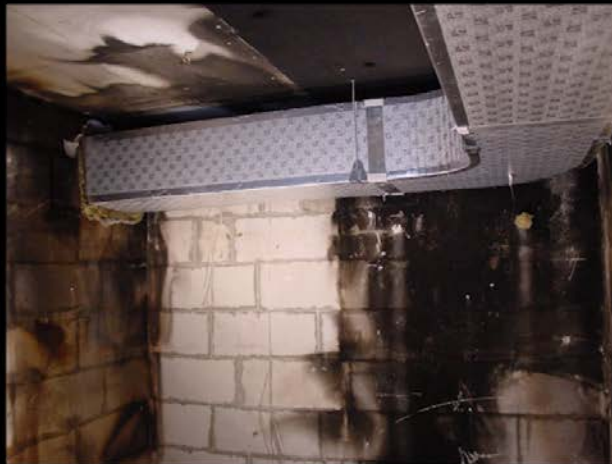
Canale preisolato in poliuretano espanso rivestito in alluminio - Classe 0-1
